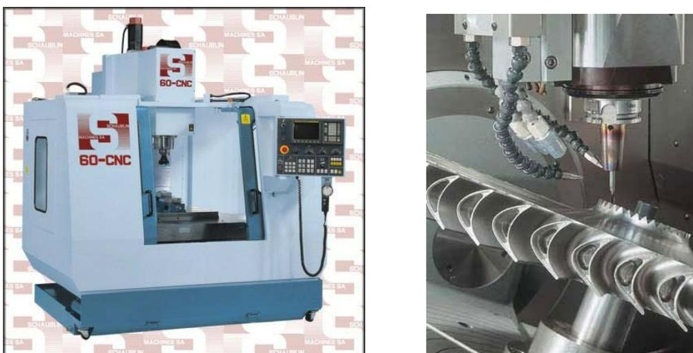
Figura 1.9 - Máquina CNC (a esquerda) e detalhe da sua ferramenta (a direita).
